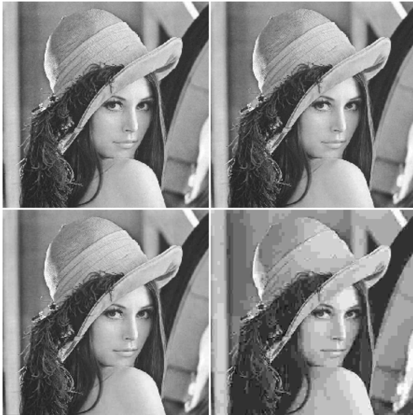
תוצאות ה-JPEG: שמאל למעלה - מקור, ימין למעלה - יחס דחיסה 7.12 ושגיאה 4.5, למטה משמאל - יחס דחיסה 11.65 ושגיאה 5.84, למטה בצד ימין - יחס דחיסה 52.27 ושגיאה 16.8
