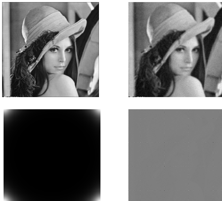
שחזור ע"י מסנן הפוך. תמונת מקור (שמאל למעלה), תמונה מקולקלת (ימין למעלה), תמונת המסנן בתדר (שמאל למטה), ותוצאת השחזור (ימין למטה).
