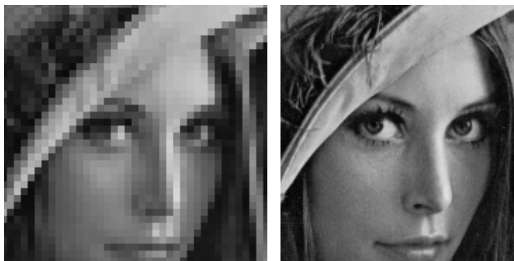
פעולת הדגימה בתמונה – חישוב ממוצע על-פני שטחי הגלאים
